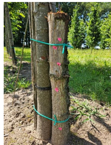
Abbildung 2. Ein Eichenstamm zur Überwachung der Bohrungen, der an einer Linde auf der Versuchsfläche befestigt ist.
