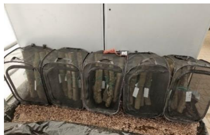
Abbildung 3. Eichenstämmchen aus dem Pflanzenschutzversuch, aufgeschlüsselt nach Behandlungsvariante, in Insektenkäfigen im Gewächshaus mit einem Temperatursensor.
